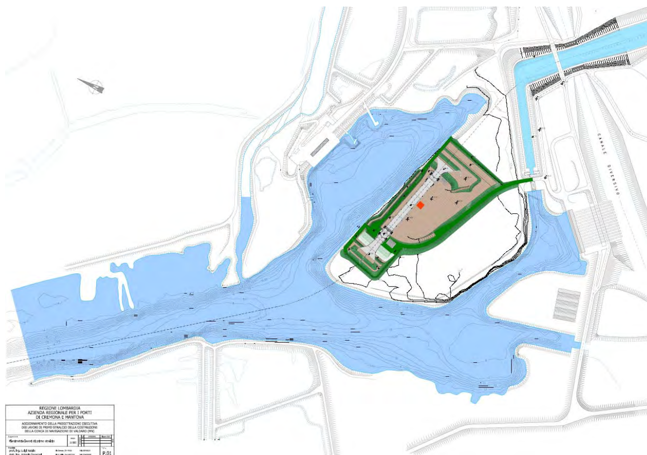
Figura 115 - Stralcio della Planimetria dei lavori di primo stralcio (Aggiornamento della progettazione esecutiva dei lavori di primo stralcio della costruzione della conca di navigazione di Valdaro (MN))
